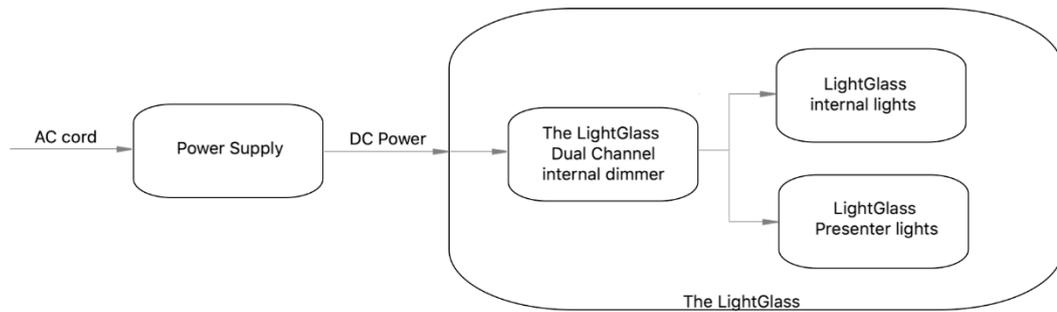
Wechselstromzuleitung-Netzteil-Gleichstrom-Zwei Kanal Flimmerfreier Dimmer-Lightboard
